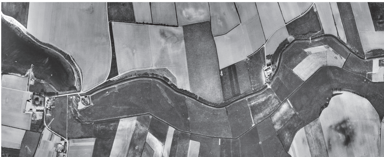
På et luftfoto fra 1954 ses den håndgravede afvandingsgrøft tydeligt ned igennem Mjels Sø og landgrøften nord om søen. Der er på dette tidspunkt dyrkede marker i hele søen.
